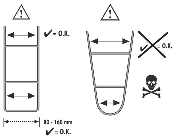
Der Top-Lock Adapter darf nur auf Gepäckträgern montiert werden, die parallel zueinander verlaufende Gepäckträgerrohre haben
