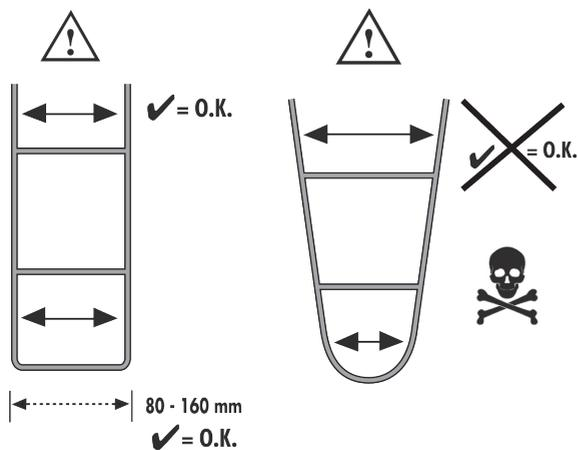
Der Top-Lock Adapter darf nur auf Gepäckträgern montiert werden, die parallel zueinander verlaufende Gepäckträgerrohre haben
