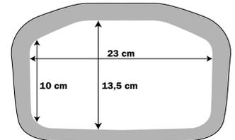
Abmessungen transparentes Deckelfach; Öffnung: 21,5 cm
