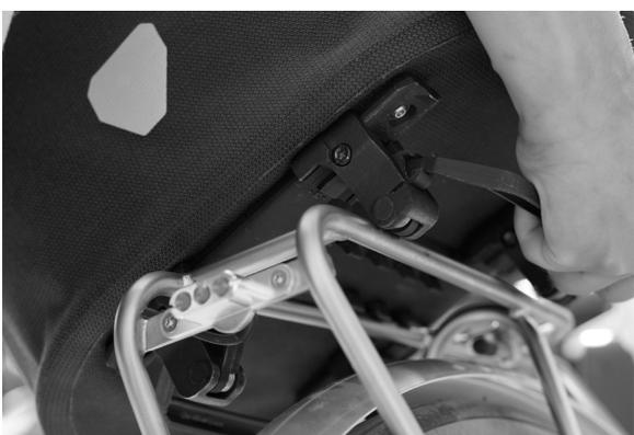
**3** Retrait rapide en appuyant sur l'un des deux Déverrouillage des poignées à gauche ou à droite.
